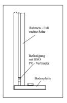
**Beispiel**: Befestigung eines Tür - Rahmenprofils auf einer Bodenplatte.
